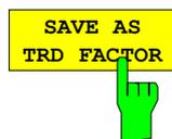
SAVE AS TRD FACTOR erzeugt aus einer normalisierten Messkurve einen Transducer Faktor mit bis zu 625 Punkten. Die Anzahl der Tabelleneinträge ist durch SWEEP COUNT festgelegt. Die Frequenzpunkte sind dabei äquidistant zwischen Start- und Stop-Frequenzverteilt. Der Transducer Faktor kann anschließend im Menü SETUP – TRANSDUCER weiter bearbeitet werden. SAVE AS TRD FACTOR steht nur bei eingeschalteter Normalisierung zur Verfügung.
